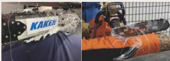
チェーンソーの刃に特殊防護材が絡みつくことで刃が停止され、足や手の切断を防ぐ構造。この特殊防護材が、ズボン、上着、手袋に縫い込まれています。
